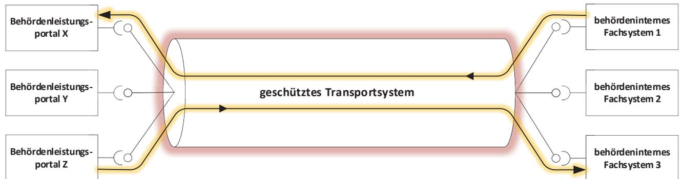
**Abbildung 71:** Geschütztes Transportsystem für den zielgerichteten Datenaustausch bzw. die bidirektionale Kommunikation zwischen Behördenleistungsportalen und behördeninternen Fachsystemen
